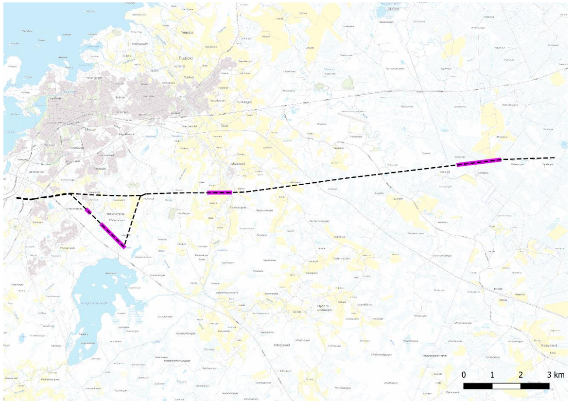
Kuva 8-11. Huomiomerkitöjä suositellaan käytettävän kuvassa violetilla rajatuille voimajohto-osuuksille.
