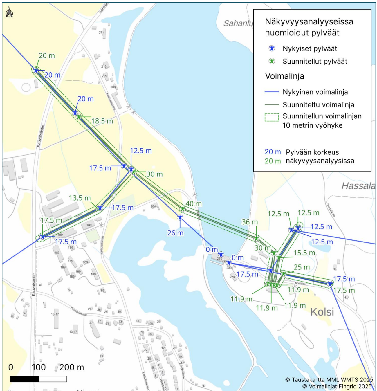
Kuva 1. Näkyvyysanalyysissä käytetyt pylväät ja niiden korkeudet. Sinisellä värillä on esitetty nykyinen ja vihreällä suunnitella oleva voimajohtoverkko.
